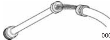
Figura 4-3. Lavado de la lanza en sentido inverso
