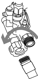
Figure 2-9. Raccord du tuyau d'alimentation en eau
